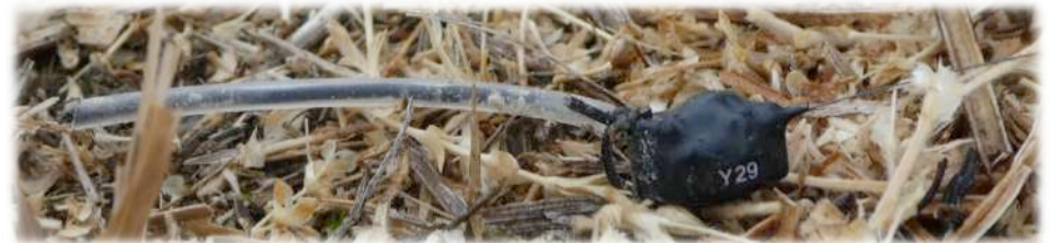
Rupture du fil d'une ceinture
